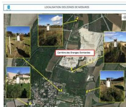
2 - Cet appareil sert à la réalisation de mesures du niveau sonore dans l'environnement de la carrière.
