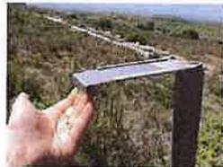
Les plaquettes qui étaient jusqu'à présent utilisées pour la mesure des poussières sédimentables sont remplacées par des jauges de 10 L maintenues par un trépied.
